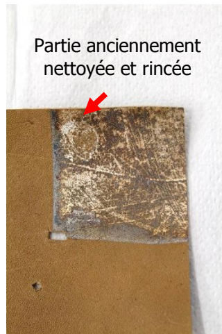
Echantillon très terni : nettoyage en modes chronoampérométrique (-1V/C. vitreux) et dynamique
