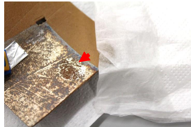
Le métal après rinçage à l'eau déionisée (décollement du film métallique)
